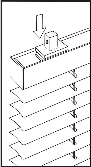
Einsetzen des "Schlittens" von oben in die Oberleiste der Jalousie.
