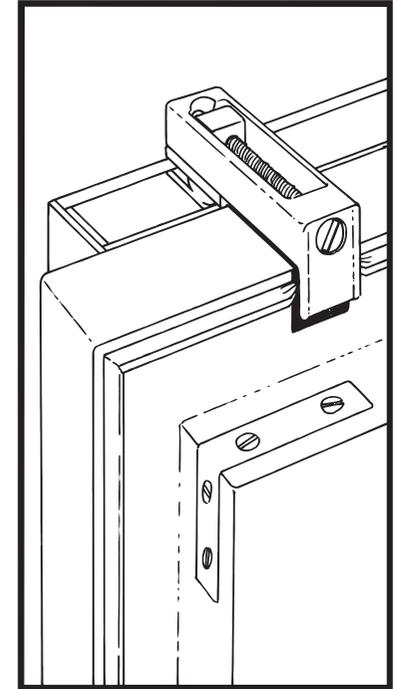
Die Jalousie wird mit den so vorbereiteten Haltern auf die obere Seite des geöffneten Fensterflügels über die Fensterdichtung gesetzt. Danach wird die Schraube solange angezogen, bis die Jalousie ausreichend Halt hat.
