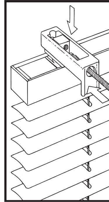
Der "Halte" wird, wie auf der Zeichnung abgebildet, auf den "Schlitten" aufgesetzt. Danach wird die Schraube durch die Bohrung im "Halte" geführt und in das Gewinde des "Schlittens" geschraubt.
