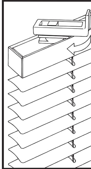
Bei einigen Jalousiemodellen kann sich das Drehen des "Schlittens" als schwierig erweisen. Verwenden Sie einfach den "Halte" wie abgebildet als Hilfsmittel zum Drehen.
