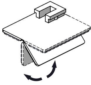
3 Die Schutzfolie unterhalb des Aufsatzes von der Klebeplatte abziehen.
