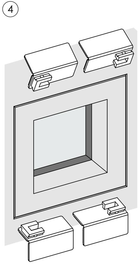
4.1 Die Klebeplatte mit der verbliebenen Schutzfolie an die Vorderseite des Fensters anlegen
