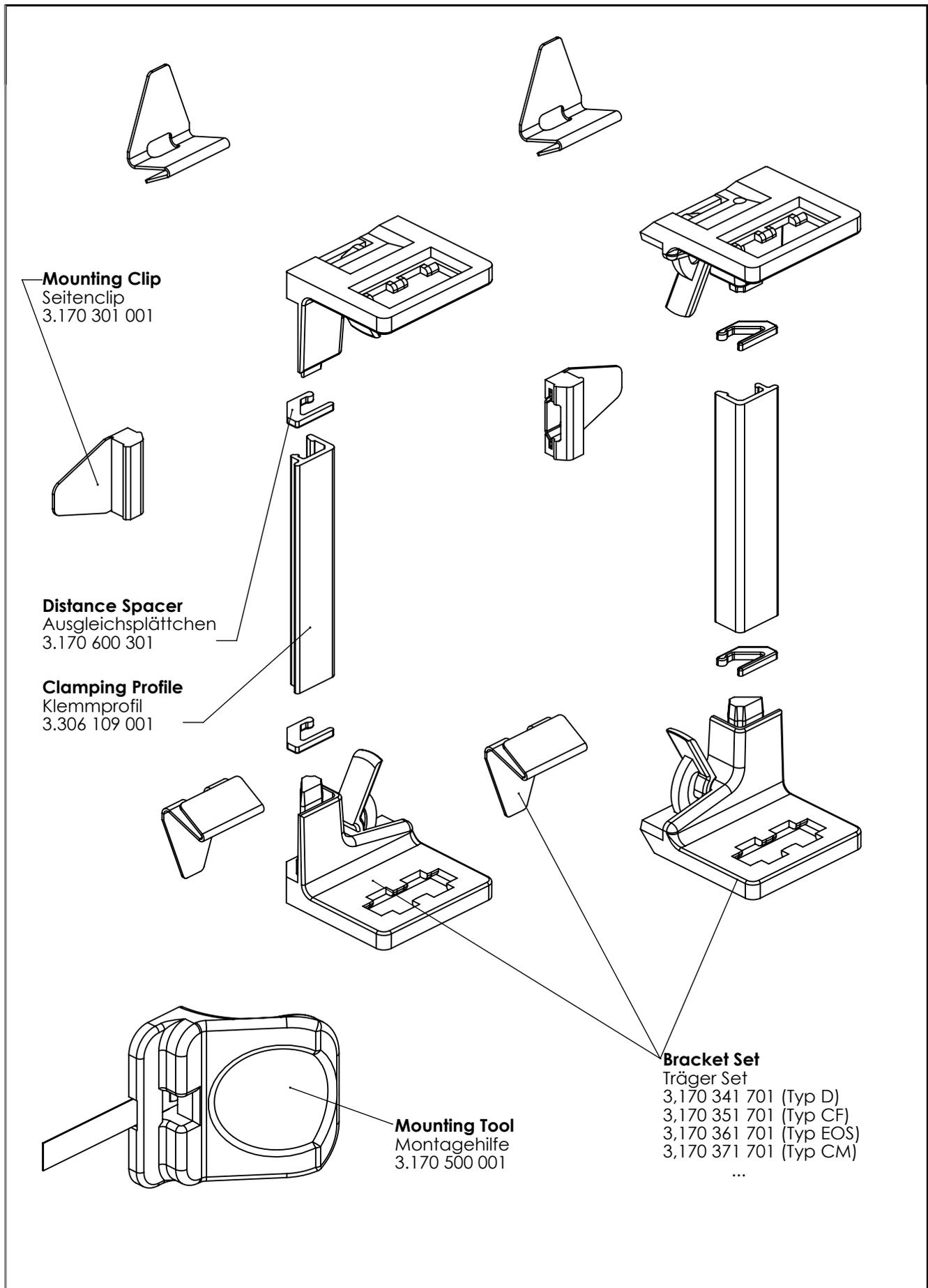
Quickfit-Klemmleiste zur Befestigung verspannter Plissees und Jalousien
