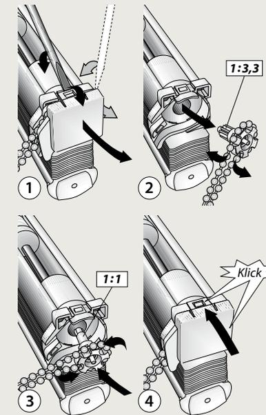
Typ K 160/250 - Getriebe wechseln
